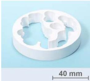
Die vorgebrannten Dentalblanks haben eine begrenzte Festigkeit und müssen sorgsam behandelt werden. Die Aufspannung auf der Fräsmaschine sollte möglichst großflächig erfolgen, um Ausbrüche oder Rissbildung zu vermeiden. Aus dem gleichen Grund sollte die Einspannung unter Einsatz möglichst geringer Spannkraft erfolgen – im Idealfall werden geeignete Drehmomente ermittelt und eingehalten – und die Aufspannvorrichtung
